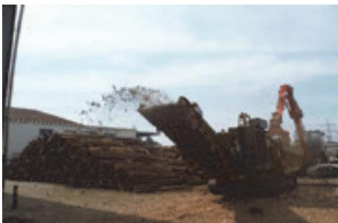
発電所のチップパー機で試験的にチップ
